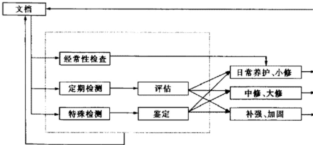
图 4.1.6 养护流程图
